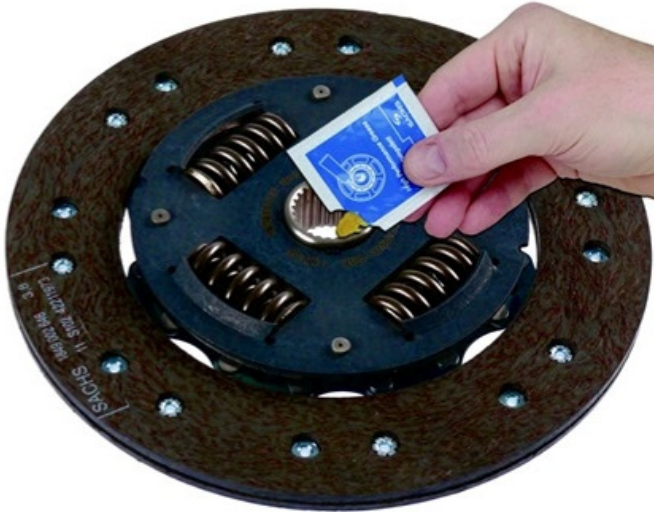
Fig. 1: Engrasar ligeramente el perfil del cubo del disco de embrague por todas partes
